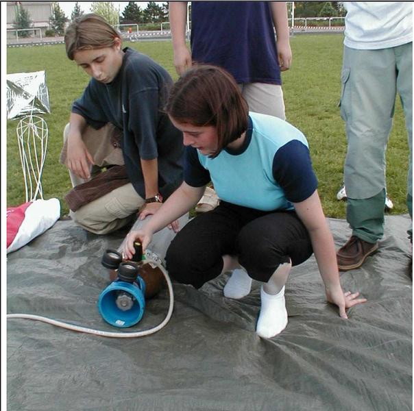
Manipulation du détendeur, ne pas se tromper de sens de rotation.
