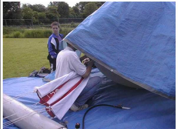
Fixation de la chaîne de vol à l'abri sous une bâche
